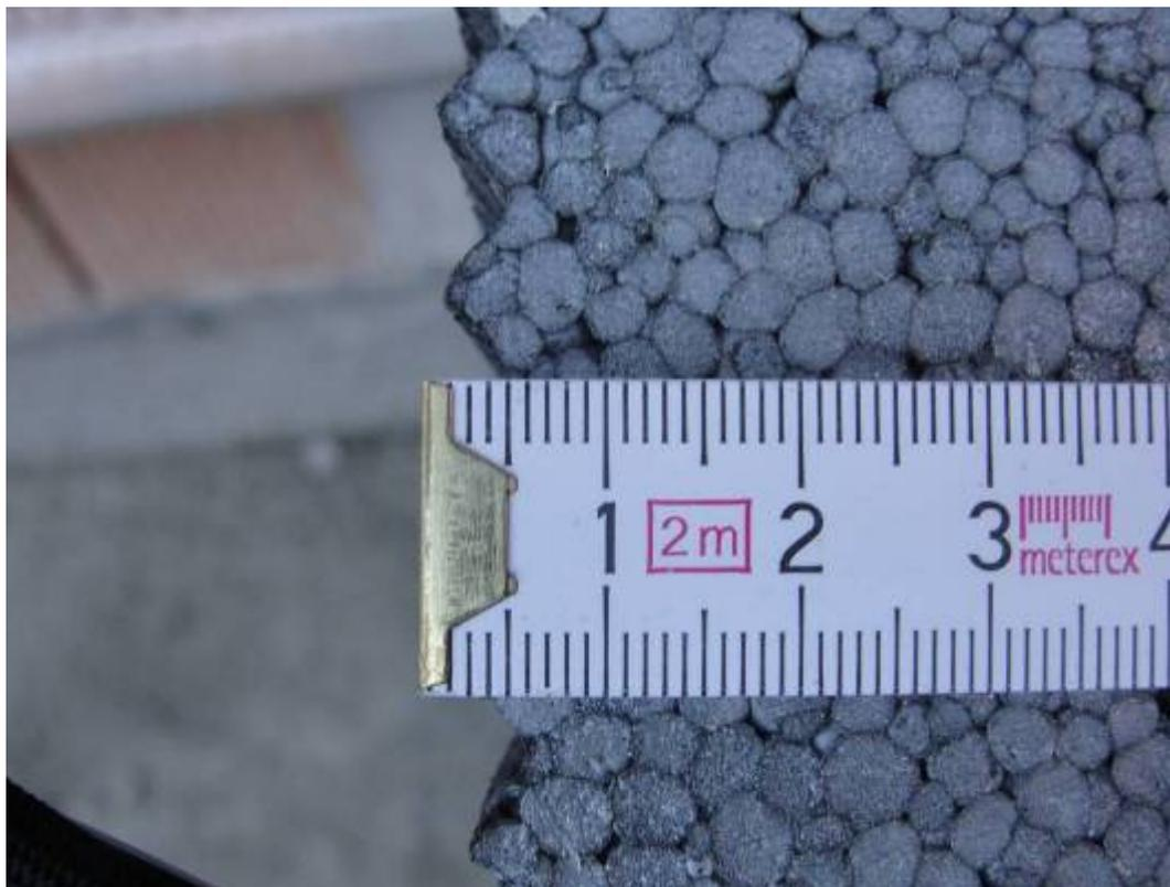
Per una corretta posa del sistema ed ottenere l'applicazione della giusta quantità di rasante/finitura, Fonostop EPS presenta una **zigrinatura** profonda **6 mm**. Questo garantisce la massa necessaria (min. 10 kg/m<sup>2</sup>) al funzionamento del sistema. **Certificato ad alta resistenza agli urti in base a UNI EN 13497**
