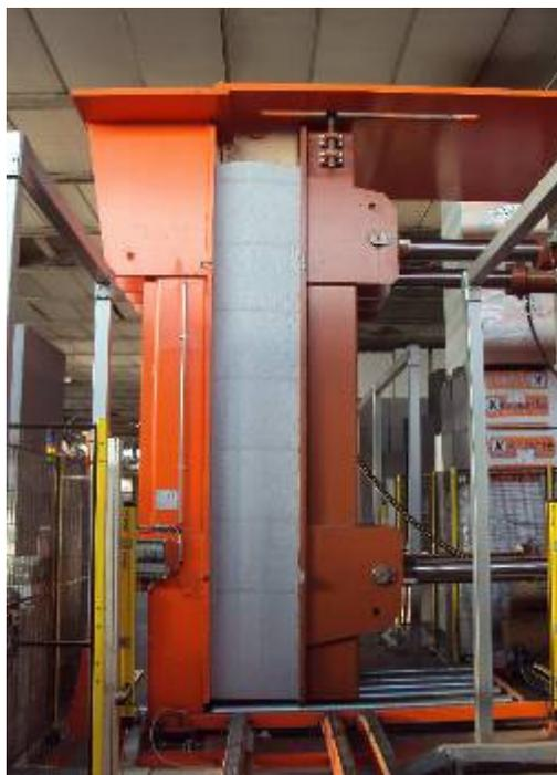
I blocchi vengono pressati con un processo produttivo controllato e bilanciato elettronicamente fino ad ottenere l'allentamento delle tensioni interne allo stesso in ogni suo punto.
